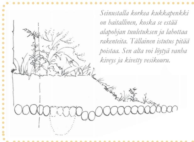
*Seinustalla korkea kukkapenkki on haitallinen, koska se estää alapohjan tuuletuksen ja lahottaa rakenteita. Tällainen istutus pitää poistaa. Sen alta voi löytyä vanha kiveys ja kivetty vesikouru.*
