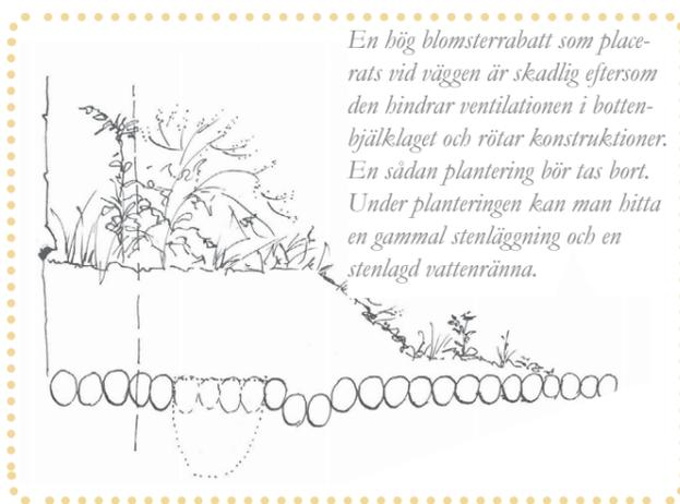
*En hög blomsterrabatt som placeras vid väggen är skadlig eftersom den hindrar ventilationen i bottenbjälklaget och rötter konstruktioner. En sådan plantering bör tas bort. Under planteringen kan man bita en gammal stenläggning och en stenlagd vattenränna.*
