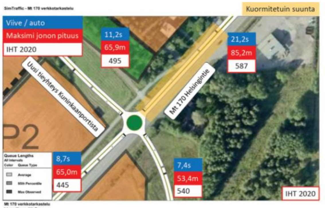
Bild 15. Utredning om anslutningar på landsväg 170 (Helsingforsvägen), cirkulationsplatsen på den nya vägförbindelsen från Kungspporten (källa: Borgå, Estbacka, landsväg 170, utredning om nätet, 2013, Linea konsultit).
