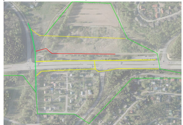
Kuva 7 Kuvassa vihreällä säilyvät yhteydet, punaisella poistuva yhteys ja keltaisella mahdolliset uudet yhteydet
