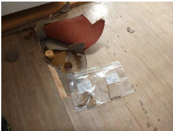
Kuva 84. Näyte kahdesta päällekkäisestä linoleumista (RM23 ja 24).
