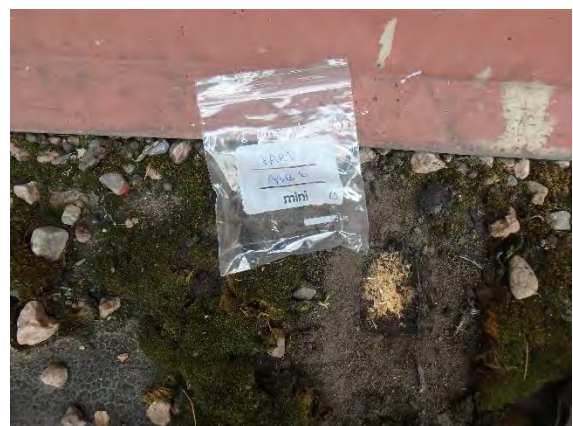
Kuva 29. Näyte vesikaton kermistä (ASB6) ei sisällä asbestia.
