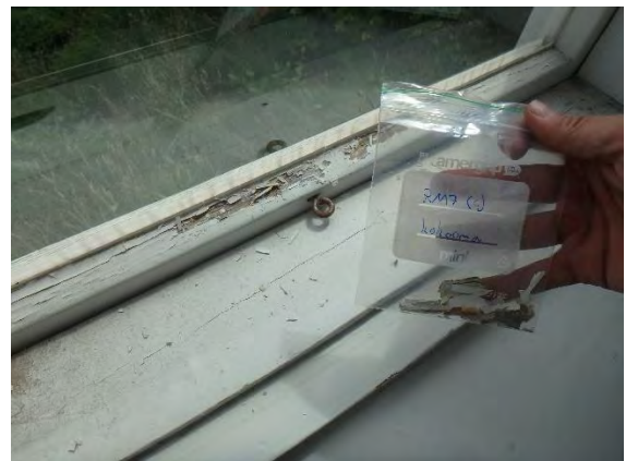
Kuva 68. Kokoamanäyte ikkunamaalista (RM7).
