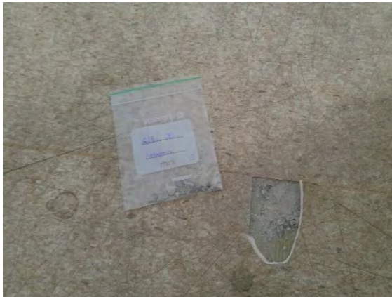
Kuva 24. Kokoamanäyte lattiatasoitteesta (ASB1) ei sisällä asbestia.
