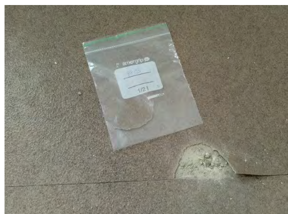
Kuva 74. Näyte porrashuoneen muovimatosta (RM13).
