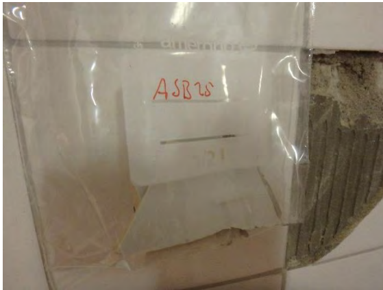
Kuva 16. Näyte seinälaatasta (kiiltäväpintainen) ja laasteista (ASB25), ei sisällä asbestia.
