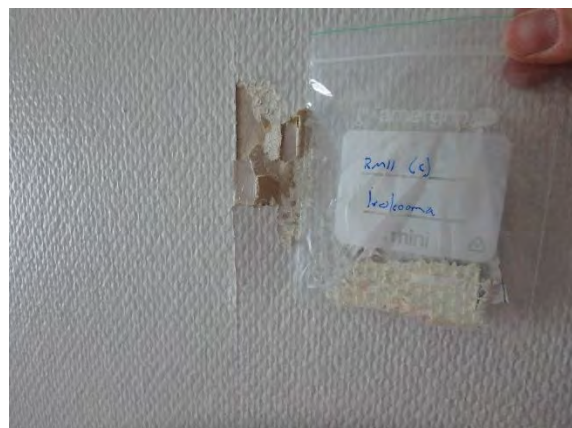
Kuva 72. Kokoamanäyte seinämaalista (RM11).
