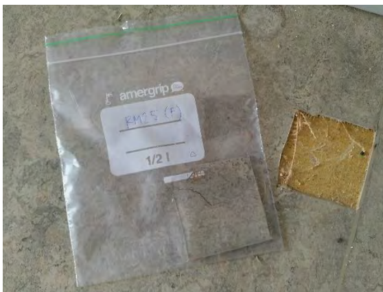
Kuva 85. Näyte huone- ja käytävätilojen lino-leumista (RM25).
