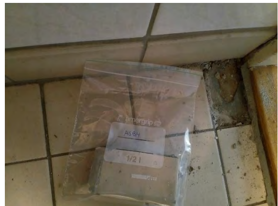
Kuva 27. Näyte lattialaatasta ja laasteista (ASB4) ei sisällä asbestia. Kiinnityslaastin alta löytyi vanha muovimatto. Muovimatosta otettiin raskasmetallinäyte.
