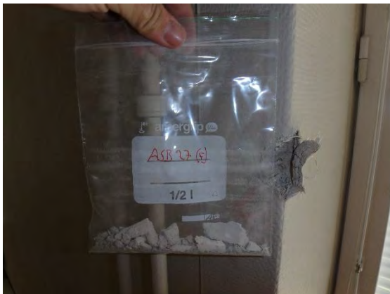
Kuva 45. Kokoamanäyte seinätasoitteesta (ASB27) ei sisällä asbestia.
