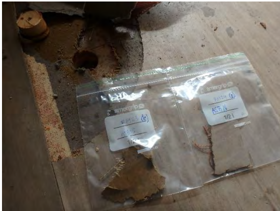
Kuva 42. Näytteet ullakkohuoneen kahdesta päällekkäisestä linoleumista (ASB15 ja ASB16) eivät sisällä asbestia.
