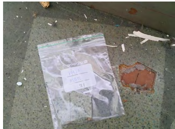
Kuva 39. Näyte ullakkohuoneiden linoleumista (ASB12) ei sisällä asbestia.
