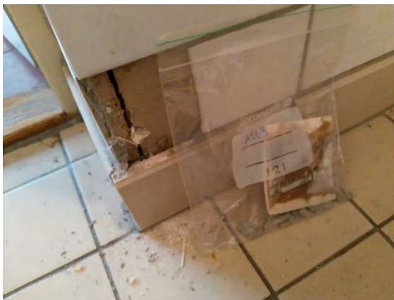
Kuva 26. Näyte seinälaatasta ja saumalaastista (ASB3) ei sisällä asbestia.
