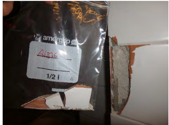
Kuva 17. Näyte seinälaatasta (mattapintainen) ja laasteista (ASB26) ei sisällä asbestia.
