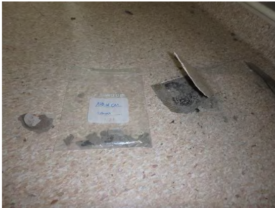
Kuva 10. Kokoamanäyte lattiatasoitteesta ja mustasta liimasta (ASB18) sisältää asbestia.
