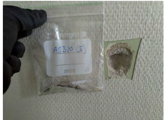
Kuva 37. Näyte seinätasoitteesta (ASB10) ei sisällä asbestia.
