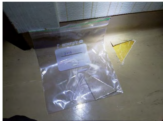
Kuva 70. Näyte wc-tilojen lattiamatosta (RM9).
