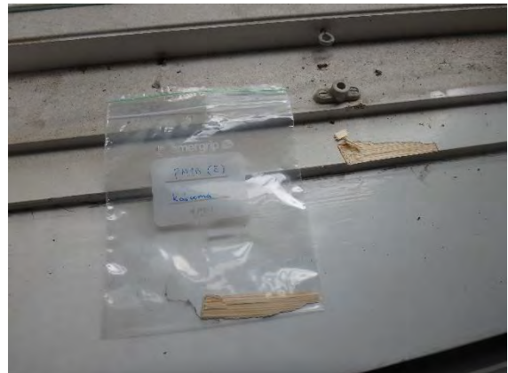
Kuva 79. Kokoamanäyte ikkunamaalista (RM18).
