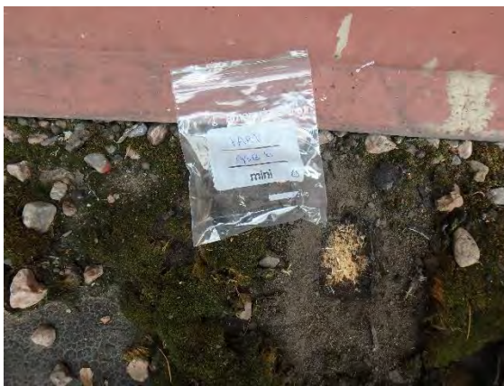
Kuva 95. Näyte vesikaton kermistä (PAH1).
