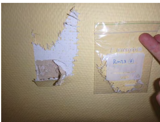
Kuva 87. Kokoamanäyte seinämaalista (RM27).
