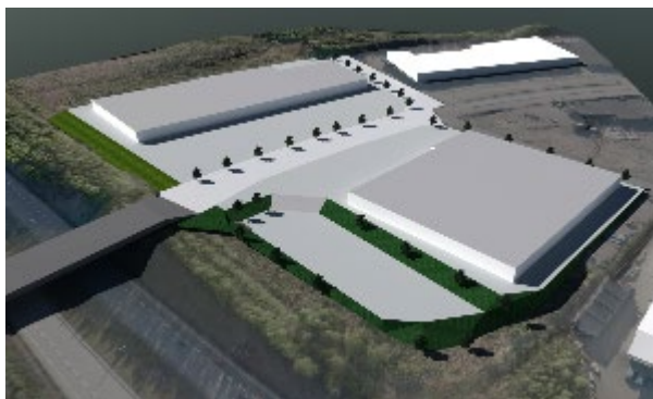
Bild 10 Utdrag ur 3D-modell, i förgrunden parkeringsområdet med lägre höjdnivå, placering av byggnaderna på tomterna och bron över motorvägen.
