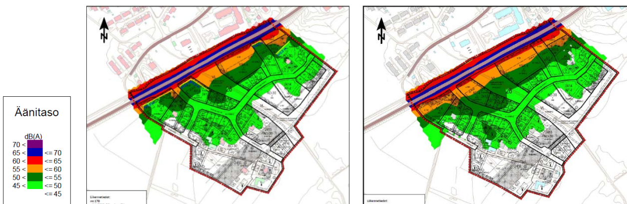
Bild: vid utkastskedet utarbetades en bullerutredning, i vilken områdets blivande byggnadsmassor beaktas. Enligt utredningen verkar den föreslagna byggnadsmassan och bullerstaket vid vägen fungera rätt så bra. Bullerskyddet på de närmaste husen nordost om servicehuset på Helsingforsvägens sida är inte helt tillräckligt. Riktvärdet dagtid är 55 dB och nattetid i nya områden 45 dB.
