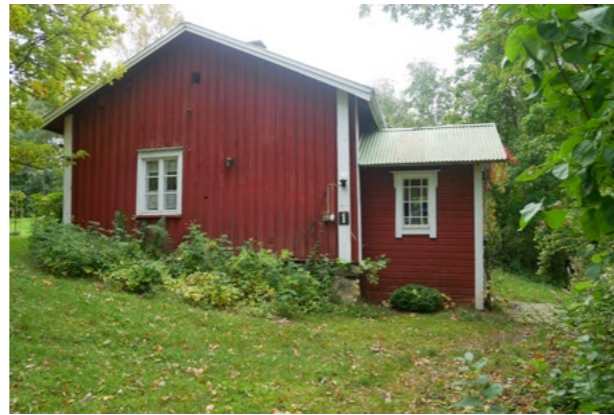
Mossakrog, som har varit gästgiveri, är ett gammalt timrat boningshus med långa knutar, sockel av natursten och tak med längsgående åsar (117). Fasaderna är fodrade med röd lockläktpanel, fönstren har förnyats.
