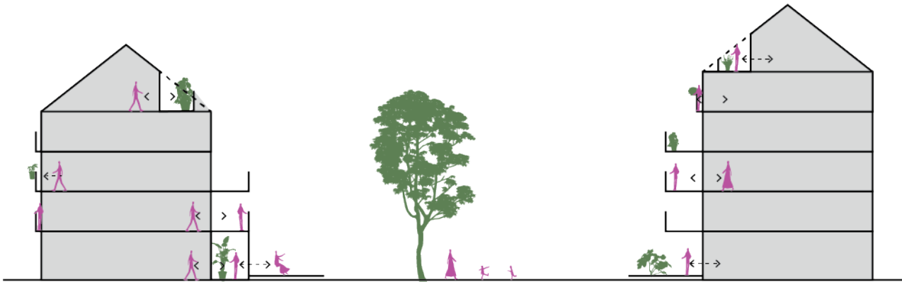
Bild 39 De olika balkonglösningarna på samma kvartersgård stöder mångsidigheten utomhus, gårdarnas ringa skala och mångsidigt byggande.
