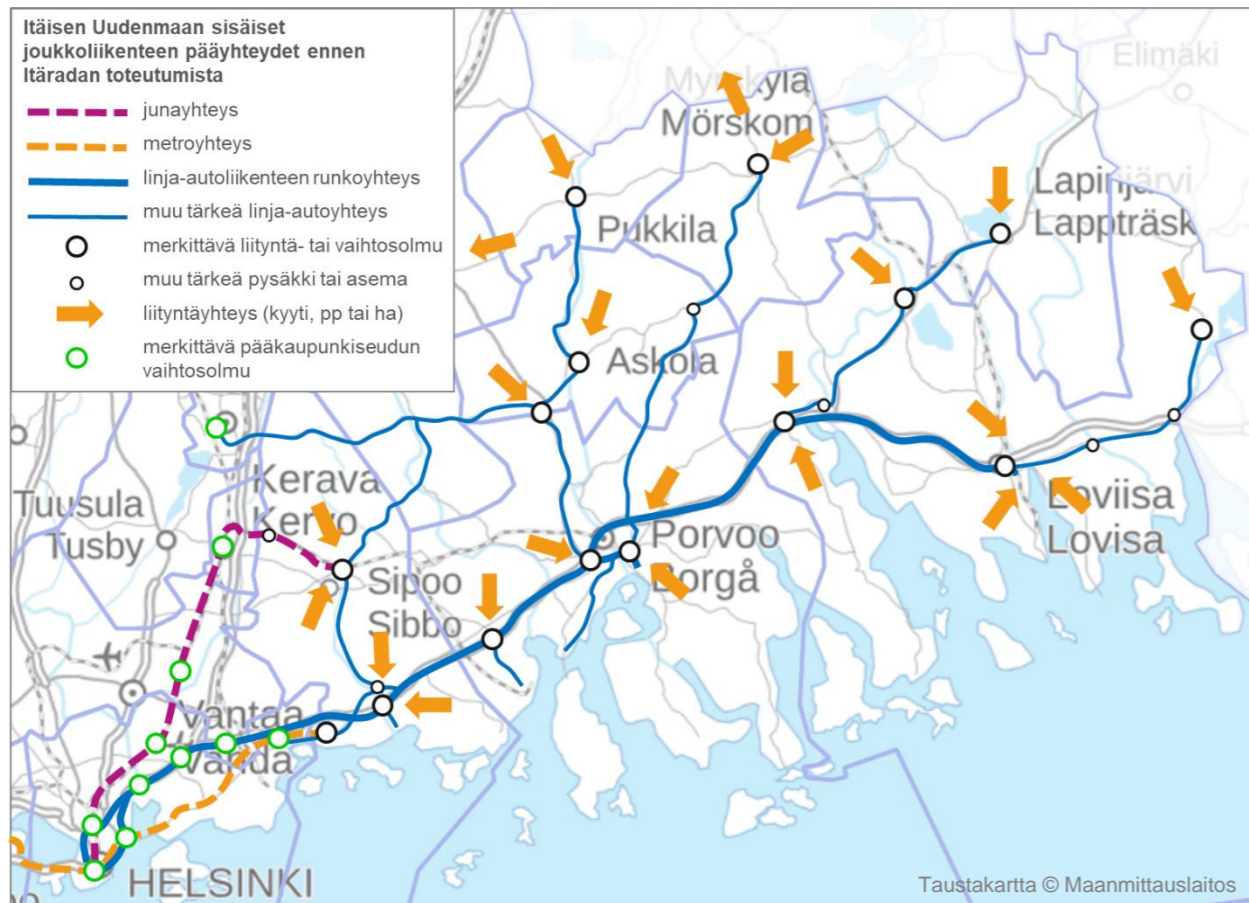
Itäisen Uudenmaan sisäisen joukkoliikennejärjestelmän periaateratkaisu ennen idän suunnan ratayhteyden toteutumista. Sinisellä merkittyjen linja-autoliikenteen nopeiden pääyhteyksien lisäksi on täydentävää perustason tarjontaa.
