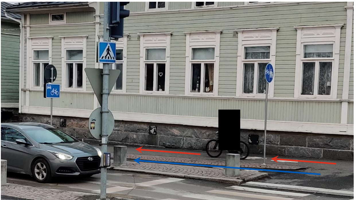
Kuva 3.21: Aleksanterinkadun-risteyksestä tuleva pyöräilijä jatkaa matkaansa jalkakäytävällä. Oikea ajolinja olisi lyhyttä yksisuuntaista pyörätietä pitkin pyöräkadun ajoradalle.
