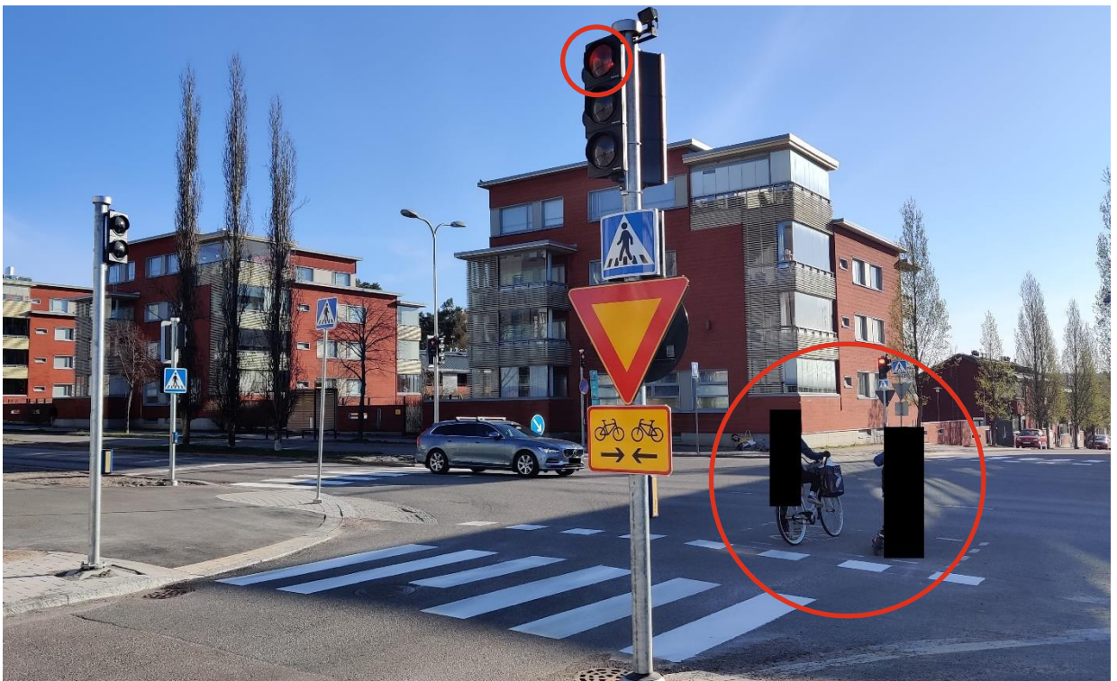
Kuva 3.33: Osa Maistraatinkadun pyöräliikenteestä käyttää Maunu Eerikinpojan kadun pitkän käännökseen ruutua pyörätaskun tapaan ja siirtyy siihen odottamaan liikennevalon vaihtumista.
