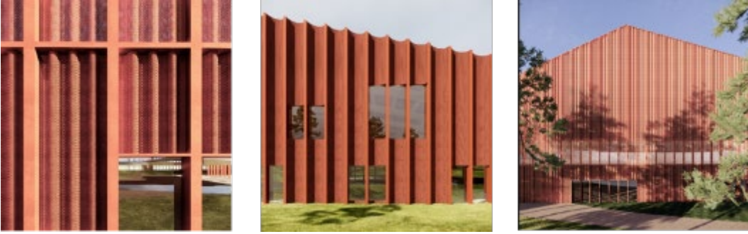
Kuva 3. Varjot luovat syvyyttä rakennuksen julkisivuun (Schauman Nordgren Architects). Julkisivuja muotoillaan lisäämällä syvyydeltään vaihtelevia pintarakenteita, jotta suuri rakennusmassa saa eloisamman ilmeen.
