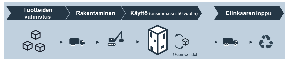
Työtilan elinkaaripäästöjen vaiheet
