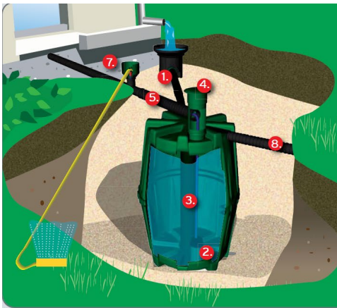
Kuva 5. Esimerkki sadeveden keruujärjestelmästä, jossa on hulevesikaivona 1600 litran säiliö. Tarkemmat tiedot löytyvät valmistajan esitteestä Meltex Herkules-säiliö.
