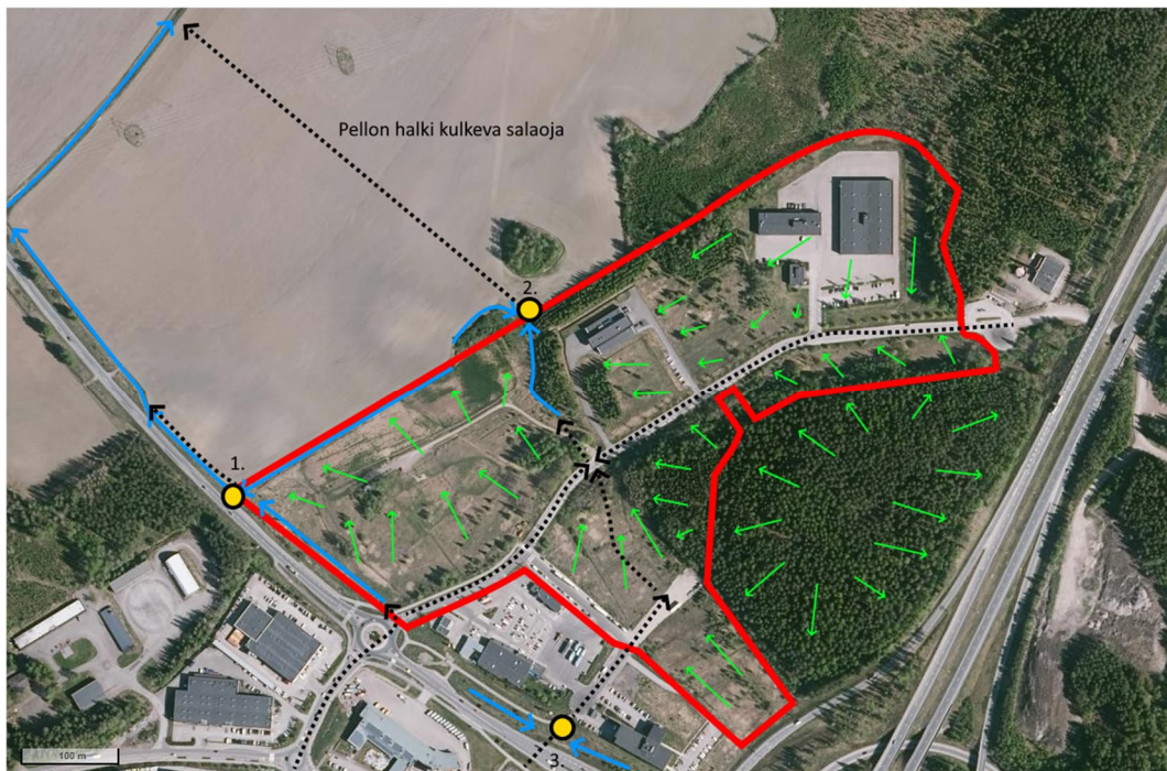
Kuva 2: Nykytilan hulevesien hallinnan ongelmakohdat suunnittelualueella.
