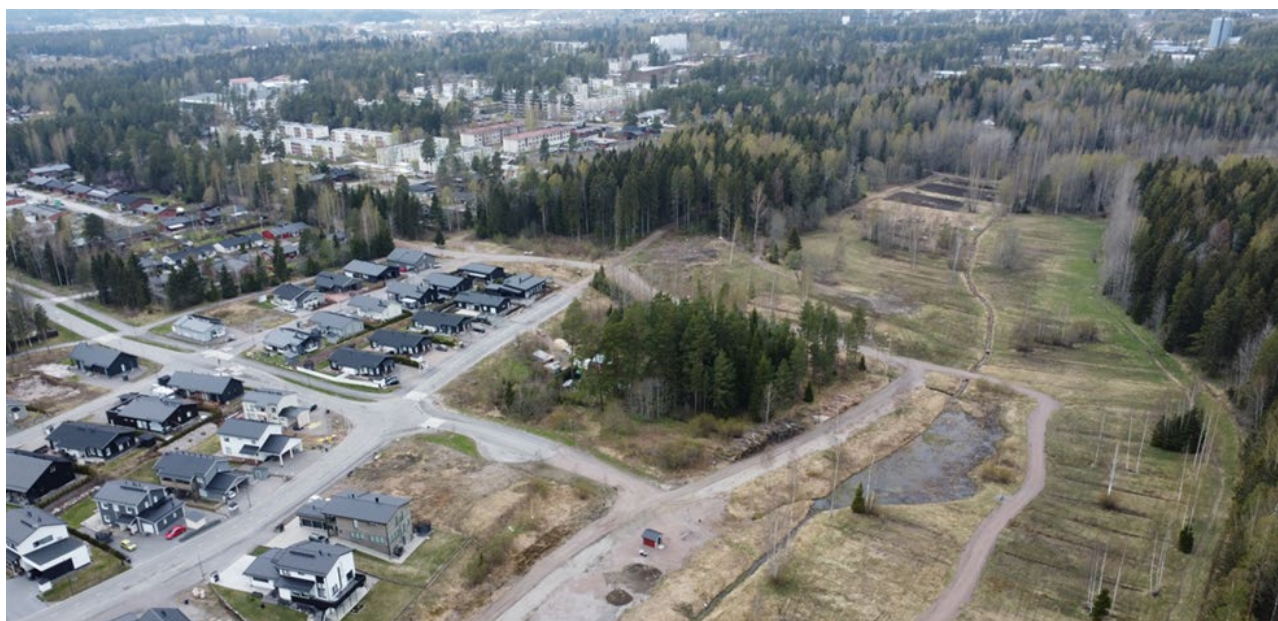
Bild 1: Flygbild från söder. En del av Vårdalen är redan bebyggd och en del endast planlagd. Längs dalens utfallsdike har en damm som jämnar ut dagvattenöversvämningarna formats. Vårdalsbacken är belägen i dalens norra ände, som syns på bilden i det övre högra hörnet som en blandskog.
