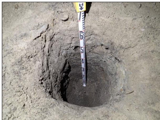
Vasemmalla: Koekuoppa 7. Lattian yläreuna on 4,96 m mpy. Sekoittunutta täyttömaata näkyy lattian alapintaan asti. Koekuopan yläreuna on 4,21 m mpy. Oikealla: Sekoittunut maa jatkuu koekuopan pohjalle 3,55 m mpy asti ja kuopan pohjaan tehdyn kairauksen perusteella 3,40 m mpy asti, minkä alta alkaa koskematon hiekka.
