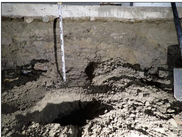
Vasemmalla: Koekuoppa 7. Lattian yläreuna on 4,96 m mpy. Sekoittunutta täyttömaata näkyy lattian alapintaan asti. Koekuopan yläreuna on 4,21 m mpy. Oikealla: Sekoittunut maa jatkuu koekuopan pohjalle 3,55 m mpy asti ja kuopan pohjaan tehdyn kairauksen perusteella 3,40 m mpy asti, minkä alta alkaa koskematon hiekka.
