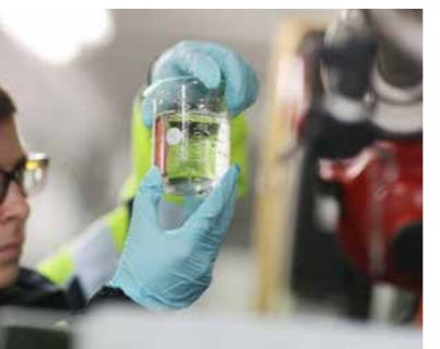
Diplomityöntekijä lida Sormanen tarkastelee kiekko-suodatuksen pilottikokeilun näytettä.
