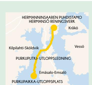
Puhdistettujen jätevesien purkuputki Svarträcksinselälle on 8 km pitkä. Utloppssledningen till Svarträcksfjärden är 8 km lång.
